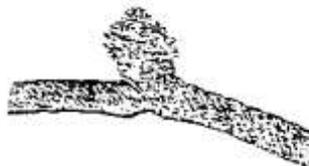
Рисунок М.9 - Перекручивание каната
